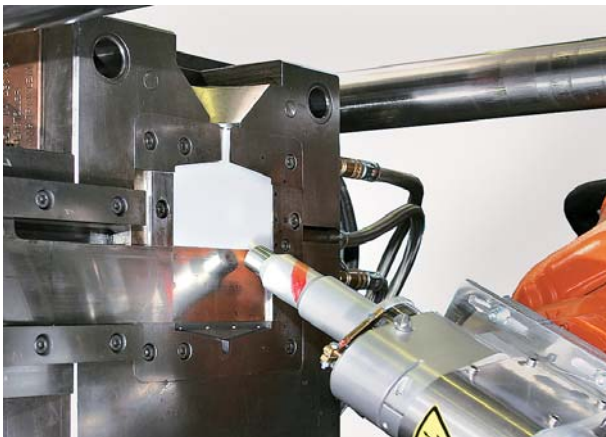
Mehrkomponentenspritzgießen mit In-Line-Plasma
