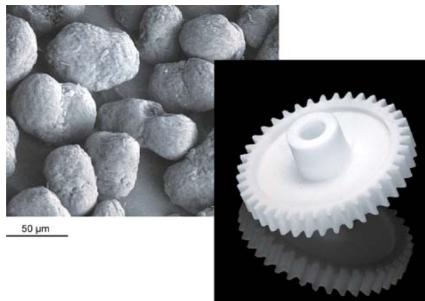
Rapid Prototyping: vom Pulver zum Bauteil Zahnrad hergestellt durch Selektives Lasersintern
