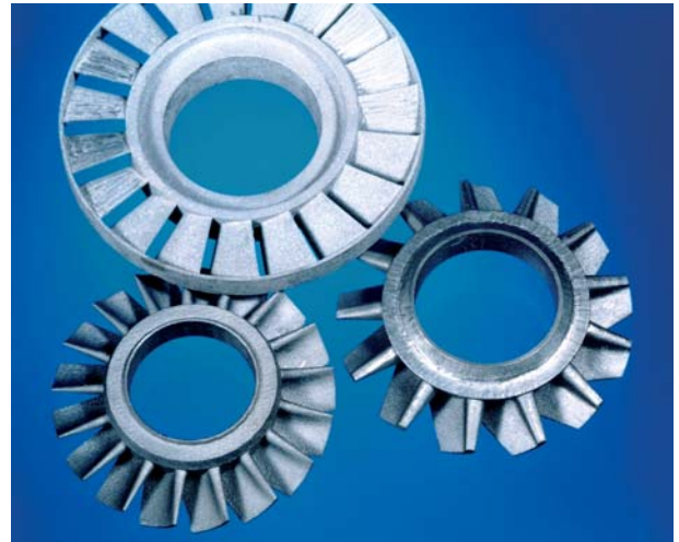
Rapid Prototyping von Leiträdern eines Drehmomentwandler
