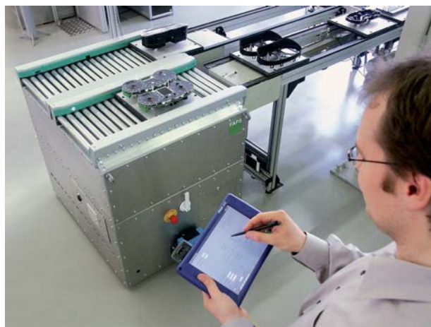
Kommunikation über das Bediengerät mit dem frei navigierenden Transportfahrzeug in der Versuchshalle
