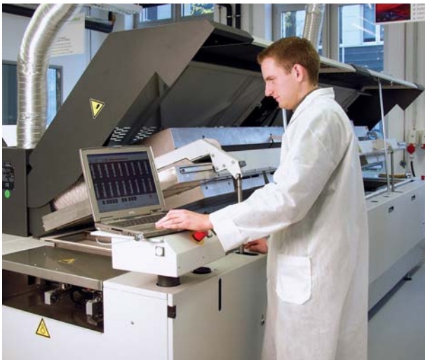
Bei der Konvektionsanlage mit 7 Zonen lassen sich die Temperaturprofile beim Löten zur Prozessoptimierung sehr differenziert einstellen
