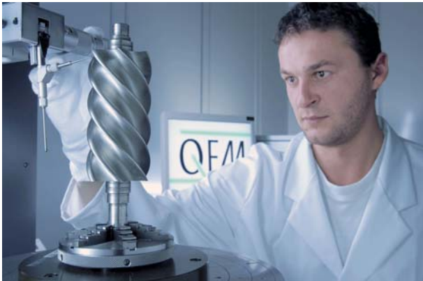
Koordinatenmesstechnische Prüfung von Präzisionsbauteilen
